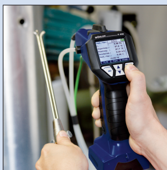
Kontrola vytápění: Měření ventilace s Wöhler A 400 PRO
